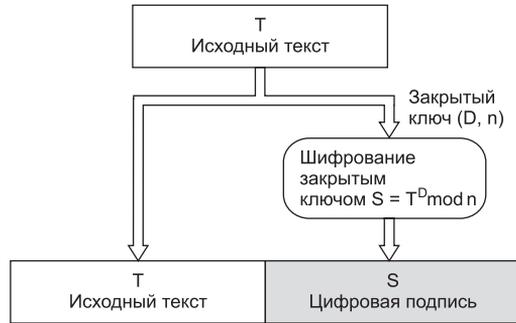
Рис. 27.6. Схема формирования цифровой подписи по алгоритму RSA
