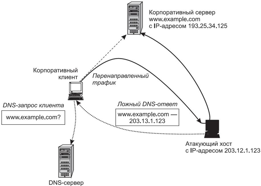
**Рис. 29.5.** Схема перенаправления трафика путем использования ложных DNS-ответов
