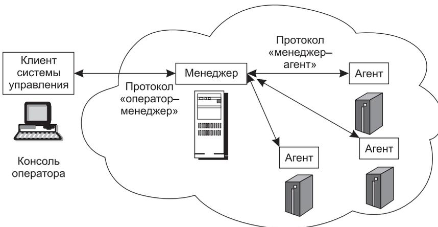
Рис. 25.2. Трехзвенная схема управления сетью
