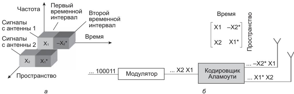
Рис. 21.12. Алгоритм Аламути: а) блоки данных, разделенные во времени и пространстве; б) излучение пары символов
