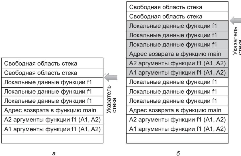
**Рис. 30.1.** а — структура стека до вызова функции  $f_2$  из функции  $f_1$ ;
