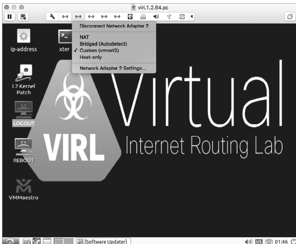
Рис. 2.3. Второй адаптер Ethernet VIRL соединен с VMnet2
