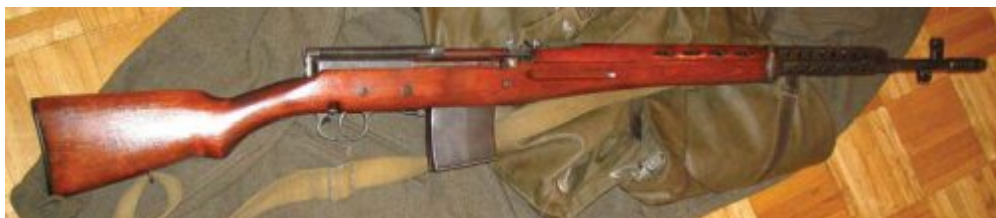
Винтовка СВТ – самозарядное оружие под трёхлинейный патрон.
